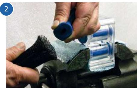
Nachdem Sie das Quetschventil in das Einführwerkzeug eingesetzt haben, drücken Sie den Flansch am oberen Ende des Ventils flach.
