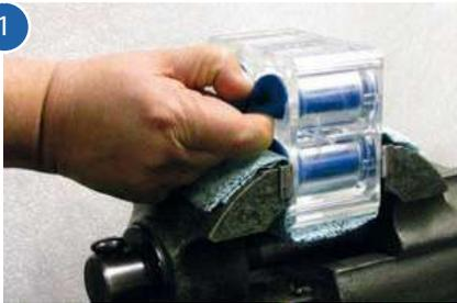
Legen Sie den Körper der Quetschventile in einen gepolsterten Schraubstock, wobei die Unterseite Ihnen zugewandt sein soll. Ziehen Sie mit einer Hand am unteren Ende des Quetschventils.
