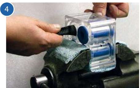
Ziehen Sie am Werkzeug, während Sie das obere Ende (UP) des Flansches zusammendrücken.
