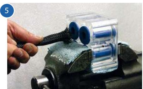
Ziehen Sie das Einsetzwerkzeug durch den Ventilkörper, bis das UP-Ende des Quetschventils und das Einsetzwerkzeug oben aus dem Quetschventilkörper austreten.
