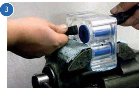
Inserire l'estremità SUPERIORE della valvola nell'utensile per l'inserimento della valvola a manicotto.
