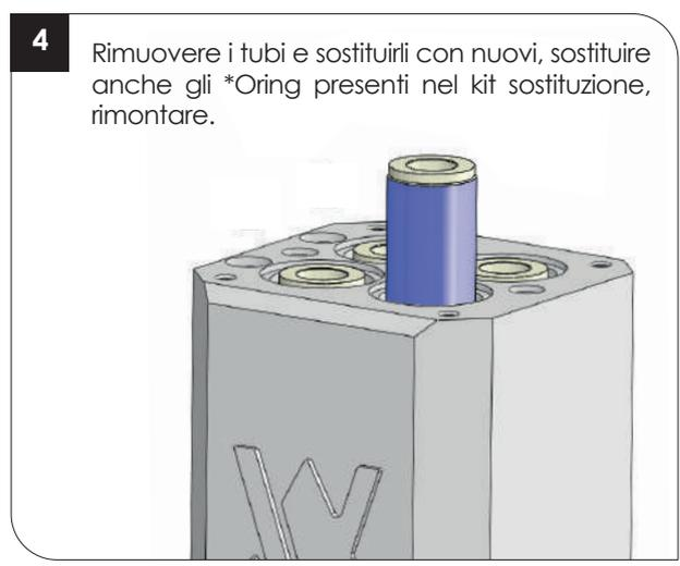
\*Nei kit dei tubi di fluidificazione sono inclusi gli O-ring. Sostituire gli O-ring se sono usurati.
