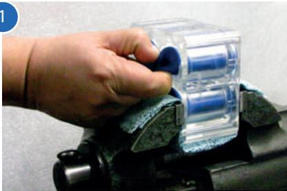
Mettere il corpo delle valvole a manicotto in una morsa imbottita con il lato inferiore di ronte a Voi. Con una mano afferrate e tirate l'estremità inferiore della valvola a manicotto.
