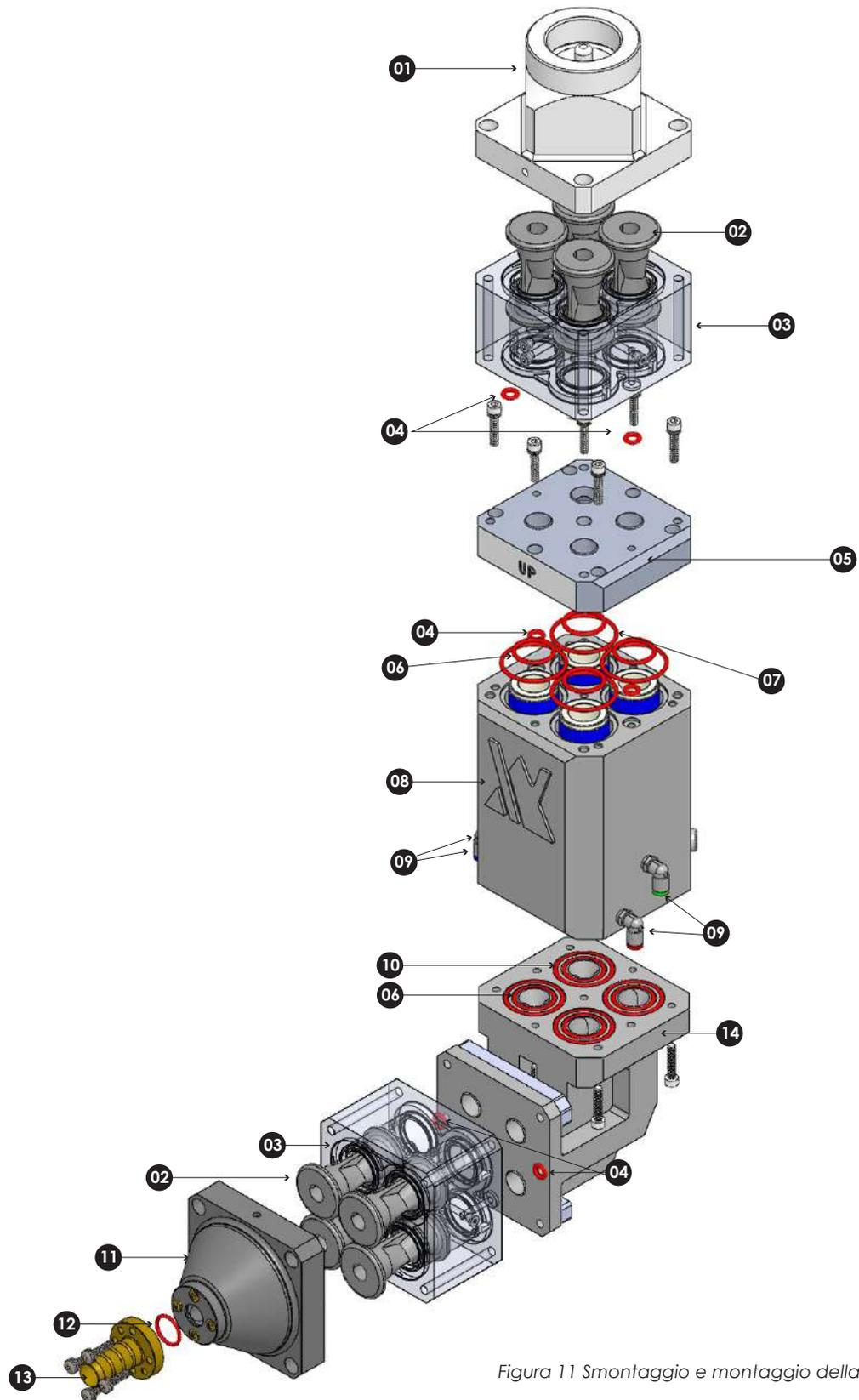
Figura 11 Smontaggio e montaggio della pompa
